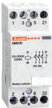
Los contactores modulares se utilizan normalmente para la conexión y desconexión de cargas en el sector residencial y de servicios. Se utilizan principalmente para el control de la iluminación o calefacción eléctrica aunque también se puede utilizar para controlar motores de un sistema de aire acondicionado o bombas. El modo de operar es idéntica a la del contactor industrial: los contactos se cierran cuando la bobina se alimenta y se abren cuando la bobina no recibe alimentación.
