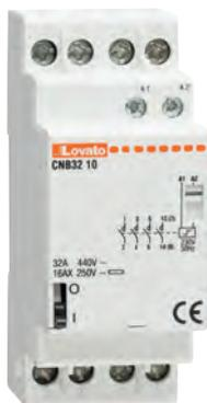
Los telerruptores funcionan con una señal de pulso. Cada pequeño pulso a la bobina cambia el estado de los contactos los cuales permanecen en su posición sin la necesidad de alimentar continuamente la bobina.
