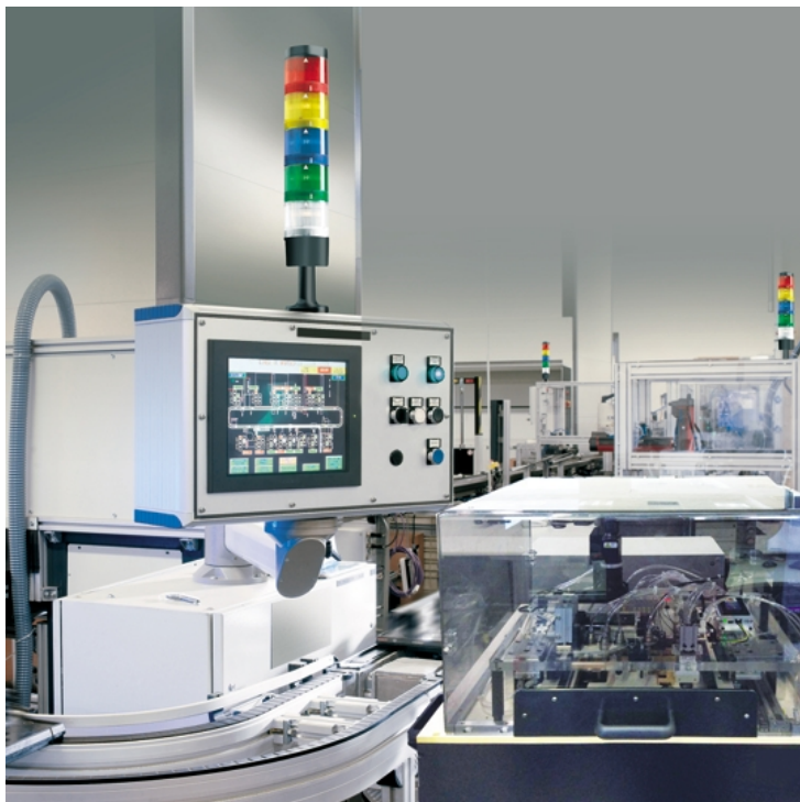
Il sistema visuale installato alla Lovato Electric di Gorle per individuare i display difettosi e da scartare
