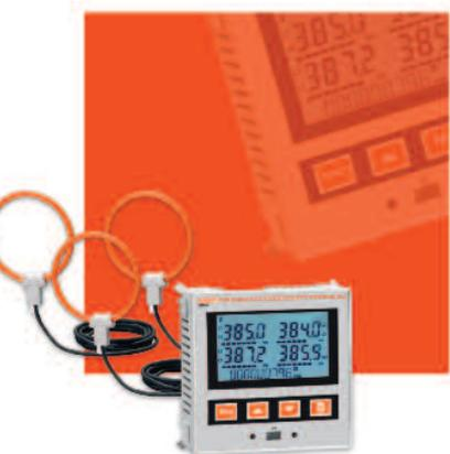
gy. Le misurazioni effettuate sono varie: oltre ai classici valori di misura vi sono parametri fondamentali, come i valori massimi, minimi e medi per tutte le misure, valori di picco di potenza e corrente, sbilanciamento della potenza attiva, analisi armonica di tensione e di corrente sino al 15° ordine e i contatore.
