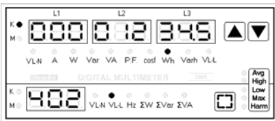
Пример счетчика энергии. Energy counter example. 1234.5 kWh
