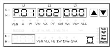
Пример коэфф ТА как 200 ( 1000 / 5). Example of CT ratio set to 200 ( 1000 / 5).
