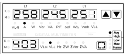
Пример (с усреднением). Example (with average enabled). L1=258A, L2=245A, L3=251A 403VL-L
